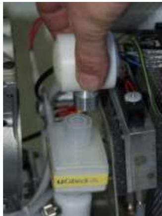
4. Retirer le filtre fin avec un léger mouvement de rotation.
