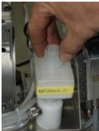
5. Tirer simplement l'insert en feutre du premier filtre hors de son support, celui-ci peut être soufflé à l'air comprimé.
