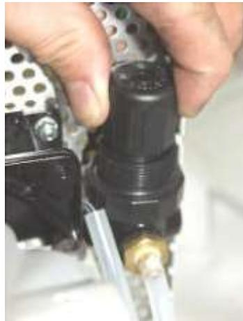
3. Tourner le bouton de réglage vers la droite dans le sens horaire pour augmenter la pression, ou vers la gauche pour diminuer la pression.
